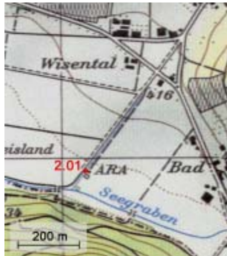
Abbildung 54: Situationsplan mit dem Geschiebesammler am Wiesenbach. Kartengrundlage: BUNDESAMT FÜR LANDES- TOPOGRAPHIE (1997b).
